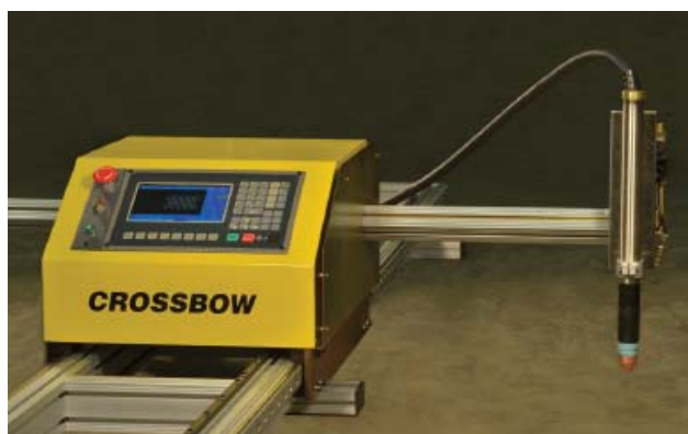
Grosime maximă de debitare cu plasmă de până la 20 mm.
