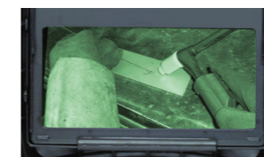
Pistolet de sudare și sârmă de sudare, poziționate perfect
